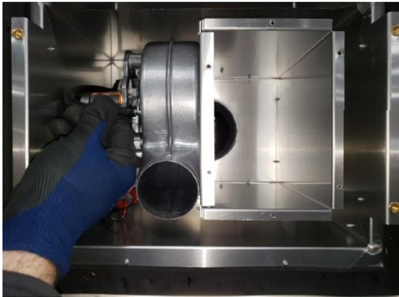
Figure 8.5 - Retirer le tube d'aspiration
