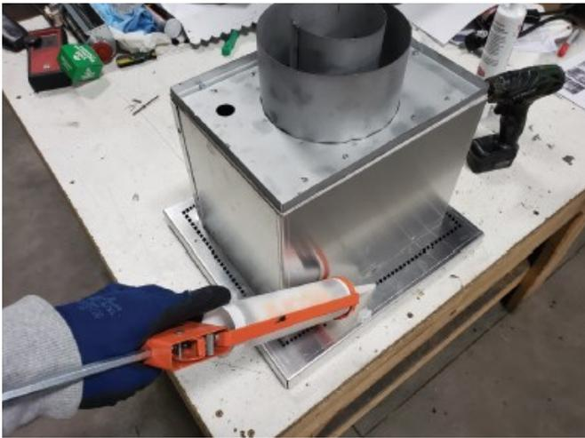
Figure 6.5 - Appliquer du silicone à la face arrière
