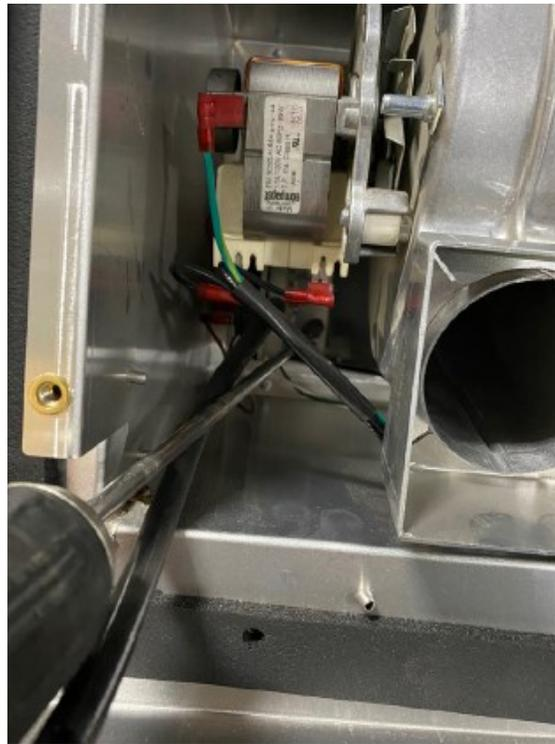
Figure 8.9 - Retrait de l'interrupteur d'aspiration
