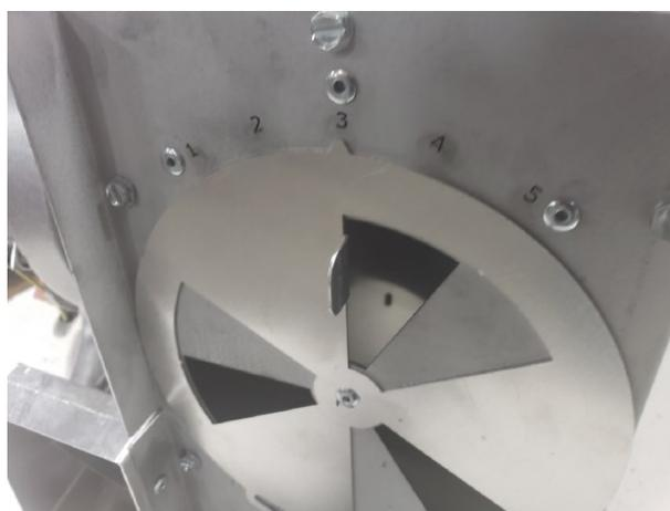
Figure 2.6 - Ajustement montré en Position 3
