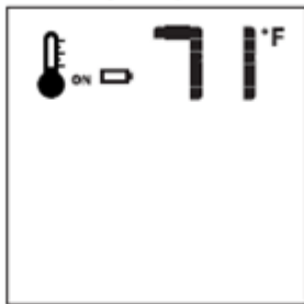
Figure 11.17 - Faible charge des piles
