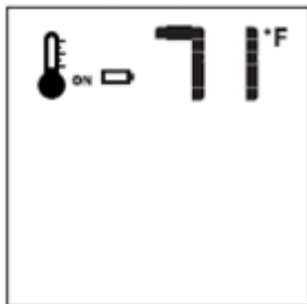
Figure 11.17 - Faible charge des piles
