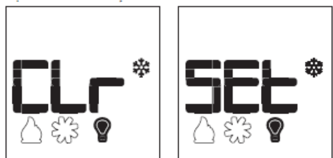
Figure 11.13 - Désactivation du réglage d'éclairage plafonnier
