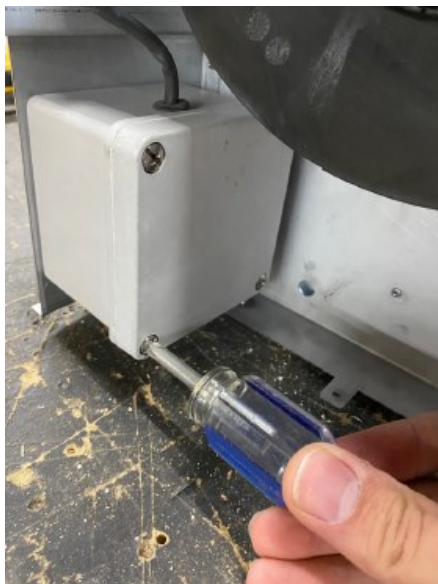
Figure 4.2 - Retrait du couvercle de la boîte électrique
