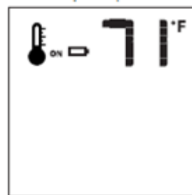
Figure 11.17 - Faible charge des piles
