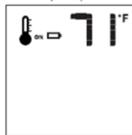
Figure 11.17 - Faible charge des piles
