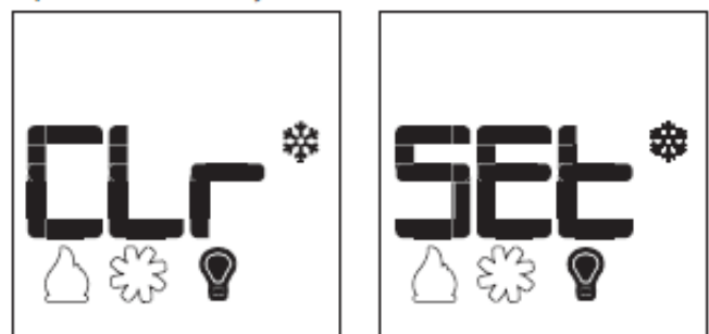
Figure 11.13 - Désactivation du réglage d'éclairage plafonnier
