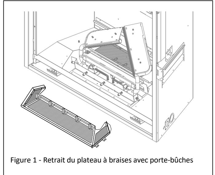
Figure 1 - Retrait du plateau à braises avec porte-bûches
