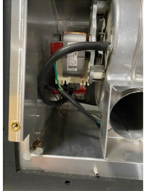
Figure 8.8 - Vis fixant le support de l'interrupteur à vide
