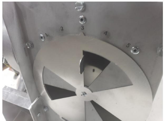
Figure 2.6 - Ajustement montré en Position 3
