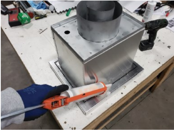
Figure 6.5 - Appliquer du silicone à la face arrière
