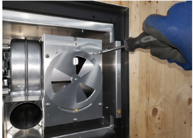
Figure 8.2 - Vis de l'évacuateur
