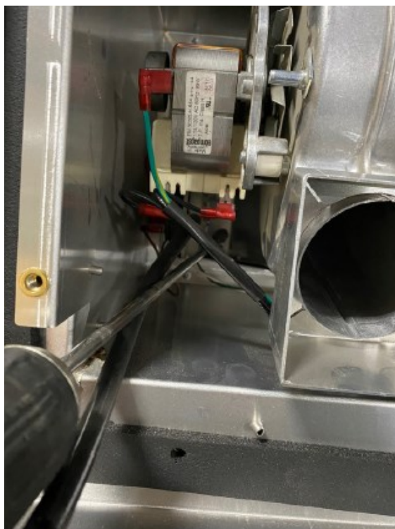
Figure 8.9 - Retrait de l'interrupteur d'aspiration
