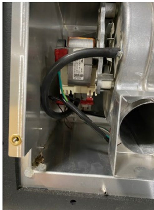
Figure 8.8 - Vis retenant le support de l'interrupteur d'aspiration
